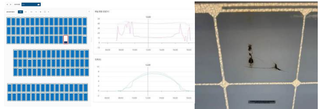
셀 파손으로 인한 누전위험 추적 (경북 상주, 49kW)
